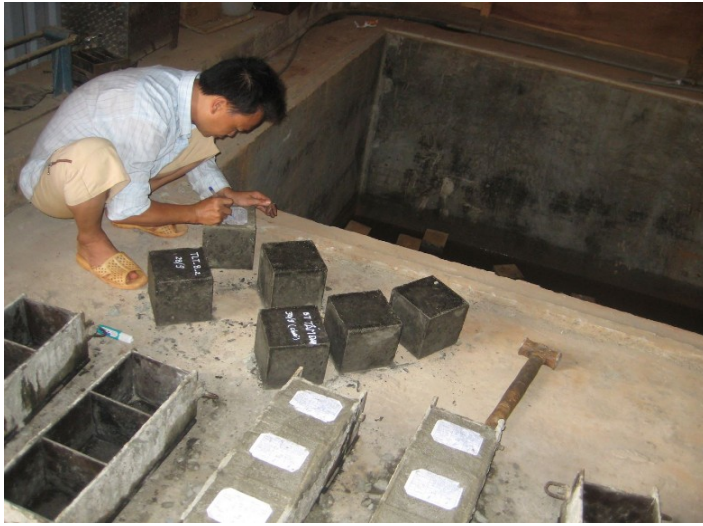
Đúc mẫu bê tông - CT Đăk Glun (Bình Phước)
