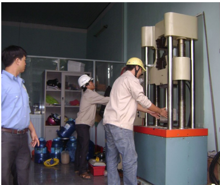
Nén mẫu bê tông trong phòng thí nghiệm
